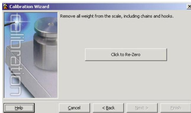
12. 如果步骤 8 选勾了“吊钩或链子”选项，去除偏置界面出现(见上页图)。从秤上移除所有重量(包括链子或吊钩)，点击“Click to Re-Zero”，校准零点偏置，完成校准零点偏置后，点击“Next”弹出如下窗口：
