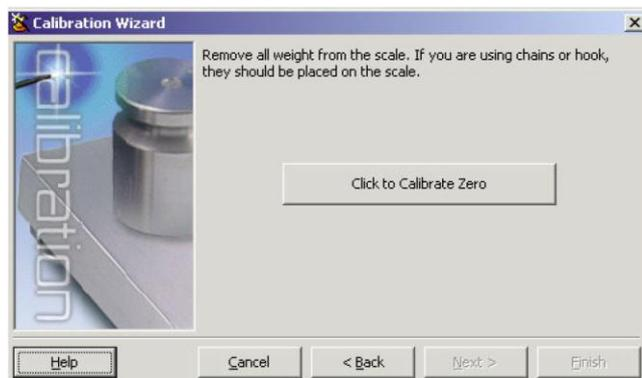
10. 从秤上移去所有重量，如果使用链子或吊钩悬挂校准砝码，把要用的链子或吊钩放到秤上，点击“Click to Calibrate Zero”，零点校准完成后，点击“Next”弹出如下窗口：
